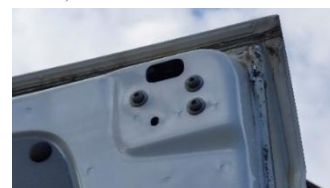
Attēls Nr.13. Dienvidkurzemes novada pašvaldības mikroautobusa durvis ar rūsū un trūkstošu skrūvi
